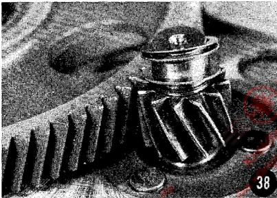
Auf Ausgleichsscheiben achten, die sowohl auf dem Kurbelwellenstumpf als auch auf der Abtriebswelle sitzen. (Bild 38 = Kurbelwelle mit Kupplungsglocke; Benennung lt. Ersatzteilliste: „Ritzel 12 Z, vollst.“.)
