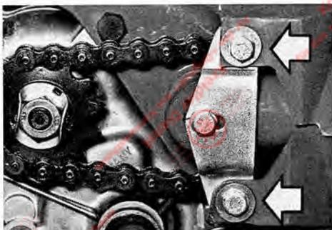
Die Muttern der BSA-Keile so weit lösen, bis das Gewinde des Keils von der Mutter leicht überragt wird; durch Schläge auf die Mutter BSA-Keile lockern. Mutter entfernen und Keile herausziehen.
