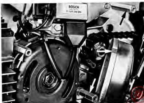
Mutter auf der Kurbelwelle unter Gegenhalten mit Anhalteschlüssel lösen (Linksgewinde), den Abzieher ins Schwungrad einschrauben und Schwungrad abziehen. Schwungrad auf gebrochene oder nicht feststehende Magnete hin überprüfen, ggf. neues Schwungrad verwenden.
