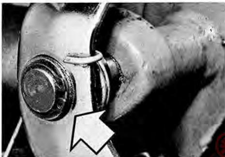
Kettenkasten abbauen und Haltebügel abschrauben.
