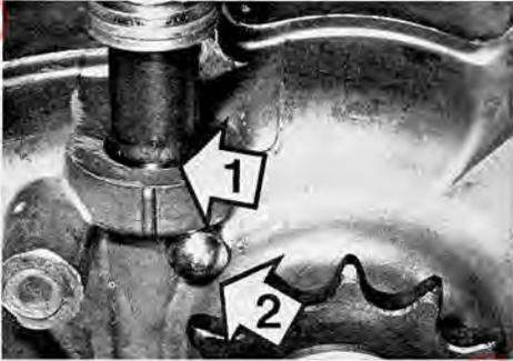
Neue Kupplungswelle in das Gehäuse einführen. Hebel befestigen. Markierungen auf dem Gehäuse, der Welle und die gedachte Mittellinie des Hebels müssen genau fluchten. Kerbnagel (Pfeil 2) eintreiben, Dichtscheibe beachten.
