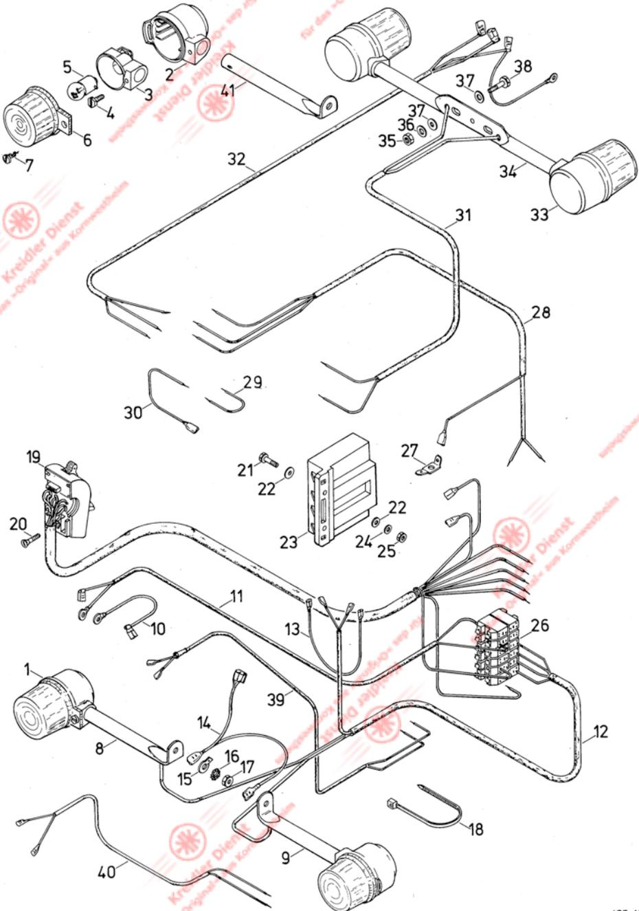
**Gruppe: Elektr. Anlage/Blinkanlage (MF 24), Kabelstränge
